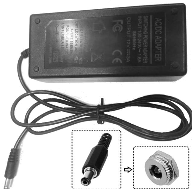
Рисунок 6 - Подключение коннетора блока питания к микроскопу ICVision
